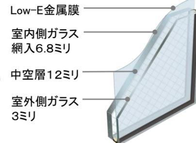
Low-E複層ガラスを標準採用。室外側にコーティングされた金属膜により高い断熱効果があります。また網入板ガラスは熱で割れても脱落せず、炎を侵入させません。
